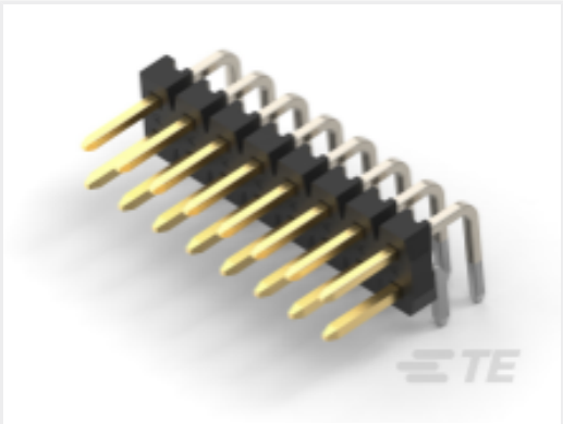
TE 产品编号 2842151-7 14P,2MM,BRK HDR,DRRT,2.8,0.38AU, TB
