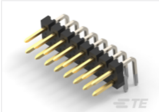
TE 产品编号 2842151-7 14P,2MM,BRK HDR,DRRT,2.8,0.38AU, TB
