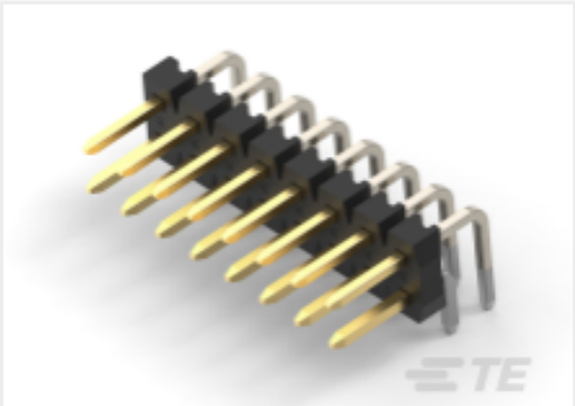
TE 产品编号 2842163-7 14P,2MM,BRK HDR,DRRT,2.8,0.38AU, BOX
