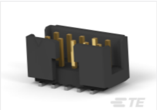
TE 产品编号 1-2842275-4 14P,2MM,SHRD HDR,DRV,T,SMD,0.38 AU,TB W/CP
