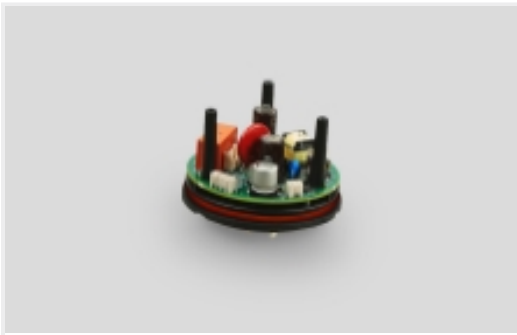
街道照明电源管理(6)
