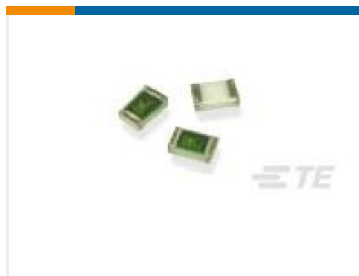
TE 产品编号6-1625867-0 RP 1J 0.166W 25R5 0.1% 25PPM 1K RL
