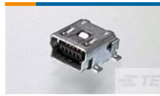
TE 产品编号1734327-2 MINI USB, TYPE A, R/A, SMT
