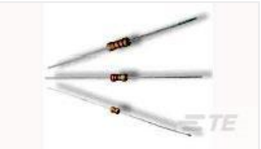
TE 产品编号1-1623929-5 CFR200 5% 1K0
