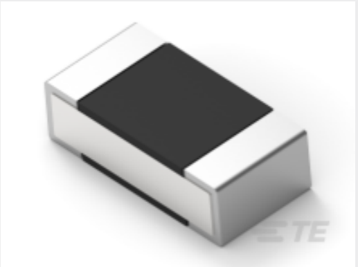
TE 产品编号5-2176307-6 RP 1E 0.1W 46K4 0.1% 25PPM 5K RL
