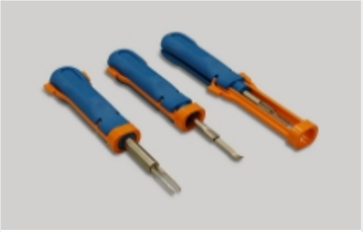
插入和拔出工具(1)
